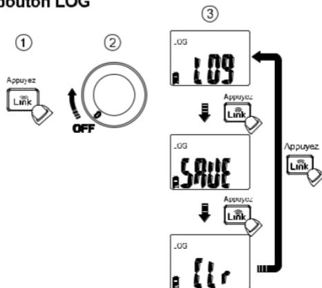
Appuyez sur le bouton **Link** lors de la mise sous tension pour sélectionner le - mode enregistreur, mode d'économie manuelle et effacer la mémoire.
