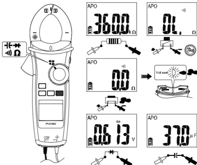
Wählen Sie den Schalter und drücken Sie die Funktionstaste, um die Messfunktion zu wählen.
