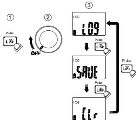
El medidor puede almacenar hasta 4000 datos en la memoria. Pulse el botón **Link** durante más de 2 segundos para activar el modo registrador de datos. El medidor entrará en modo de ajuste de intervalo de tiempo. Pulse de nuevo el botón **Link** para seleccionar el intervalo de tiempo. El intervalo puede ser de 1 segundo, 5 segundos, 10 segundos, 30 segundos y 60 segundos.
