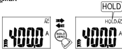
Das Messgerät piept kontinuierlich und die Anzeige blinkt, wenn das gemessene Signal um 50 Zählerstände größer ist als der Anzeigewert. (Es kann jedoch nicht über die AC- und DC-Spannung / Strom erkennen).
