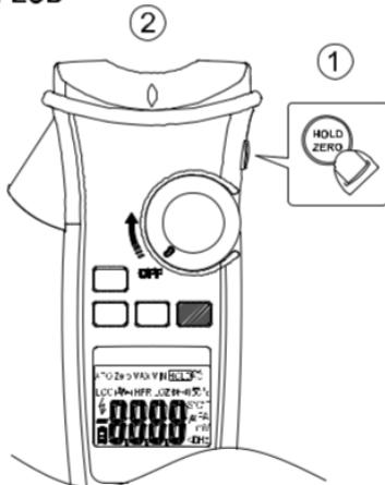
Para encender el medidor después de mantener pulsado el botón RETENER.
