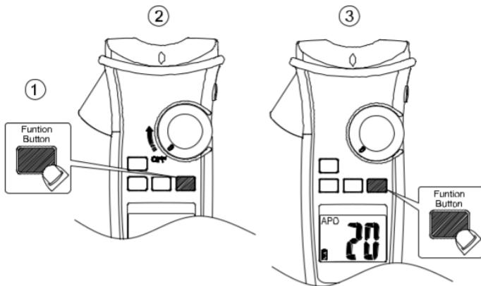
Pulse el botón de función y encienda el medidor. A continuación, pulse el botón de función para seleccionar la hora. El temporizador puede ser de 5 minutos, 10 minutos, 20 minutos y deshabilitado (OFF).
