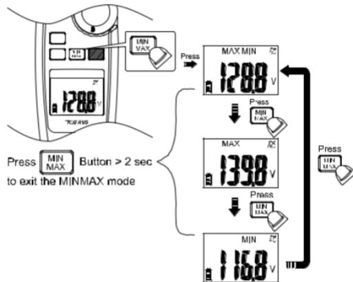
La modalità MAX/MIN registra i valori di input min e max Quando l'input va sotto il valore min registrato o sopra il valore max registrato, il tester registra il nuovo valore. Premere il pulsante Hold per mettere in pausa la registrazione.
