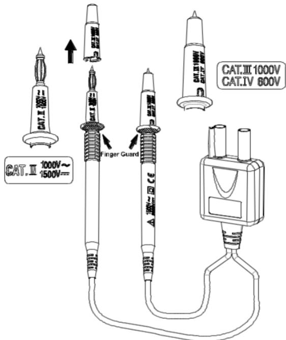
Para entornos CAT III o CAT IV, utilice los puntas de prueba con la tapa protectora de la sonda asegurada. Sin la tapa protectora de la sonda, las puntas de prueba se pueden utilizar únicamente en entornos CAT II.
