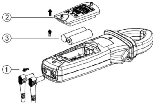
Rimuovere i conduttori di prova prima di aprire la porta della batteria o la scatola del Tester.
