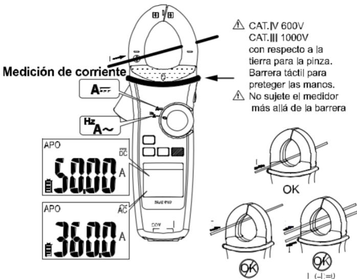
Ponga el dial y pulse el botón Función para seleccionar la función de medición.
