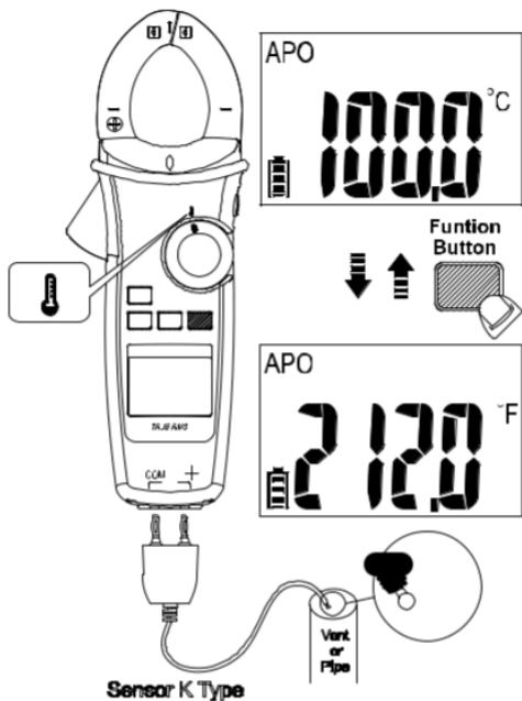
Composez le commutateur et appuyez sur le bouton de fonction pour sélectionner le mode °C / °F.
