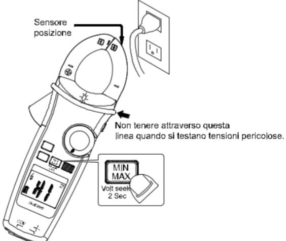
Premere il pulsante MIN/MAX per più di 2 sec. Per entrare o uscire dalla modalità Ricerca Volt Premere il pulsante MIN/MAX per scambiare fra sensibilità alta/bassa.
