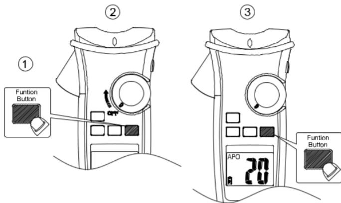
Drücken Sie die Funktionstaste und schalten Sie das Messgerät ein. Drücken Sie dann die Funktionstaste, um die Uhrzeit auszuwählen. Die Zeit kann 5 Minuten, 10 Minuten, 20 Minuten und deaktiviert (AUS) sein.
