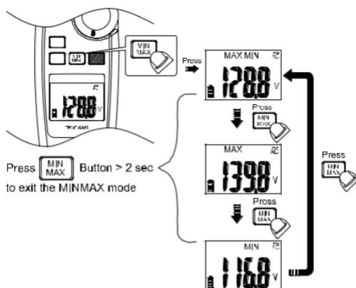
Le mode MAX / MIN enregistre les valeurs d'entrée min et max. Lorsque l'entrée descend en dessous de la valeur minimale enregistrée ou dépasse la valeur maximale enregistrée, le compteur enregistre la nouvelle valeur.
