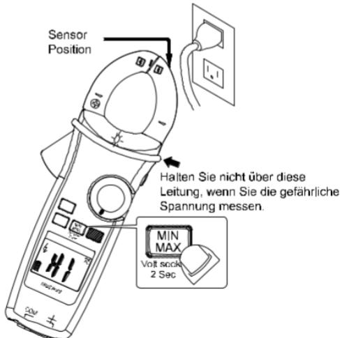
Drücken Sie die MIN/MAX-Taste länger als 2 Sekunden, um den Volt-Suchmodus aufzurufen/zu verlassen. Drücken Sie die MIN/MAX-Taste, um zwischen hoher und niedriger Empfindlichkeit umzuschalten.
