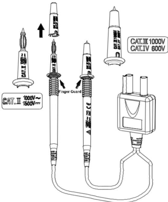
Pour les environnements CAT III ou CAT IV, utilisez les cordons de test avec le capuchon de protection de l'extrémité de la sonde fixé fermement. Sans le bouchon de protection de la pointe de la sonde, les fils de test peuvent être utilisés dans un environnement CAT II UNIQUEMENT.
