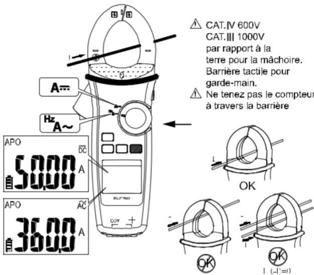
Composez l'interrupteur et appuyez sur le bouton Fonction pour sélectionner la fonction de mesure.
