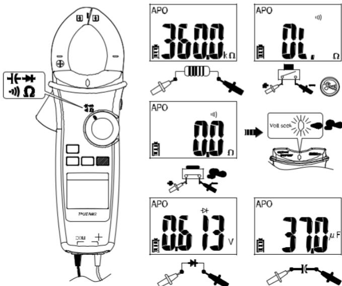
Ponga el dial y pulse el botón Función para seleccionar la función de medición.
