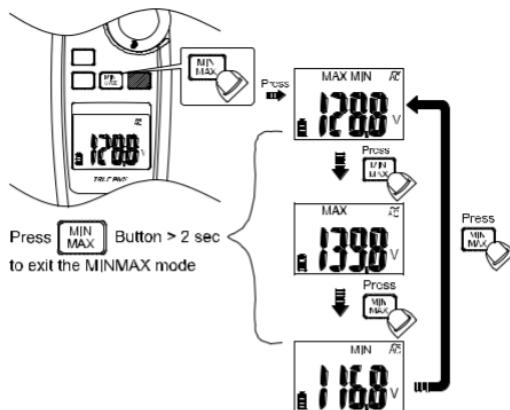
Der Modus MAX/MIN zeichnet die minimalen und maximalen Eingangswerte auf. Wenn der Eingang unter den aufgezeichneten Minimalwert oder über den aufgezeichneten Maximalwert geht, zeichnet das Messgerät den neuen Wert auf. Drücken Sie die Taste Halten, um die Aufnahme anzuhalten.
