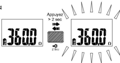
Appuyez sur le bouton de fonction pendant plus de 2 secondes pour activer / désactiver le rétroéclairage.
