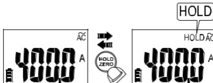
Il tester emetterà un beep continuo e il display lampeggerà se il segnale misurato è superiore di 50 conteggi rispetto alla lettura del display (Tuttavia non può rilevare attraverso la Tensione/Corrente ca e cc).
