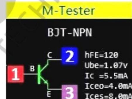
Aici testerul multifuncțional poate distinge între BJT-NPN, BJT-NPN cu diodă, BJT-PNP și BJT-PNP cu diodă.
